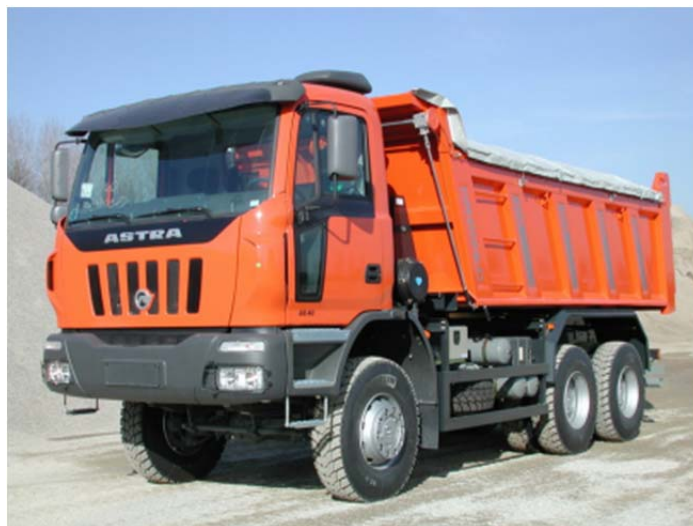
Figura 1 – Esempio di mezzi impiegati per il trasporto dello smarino
